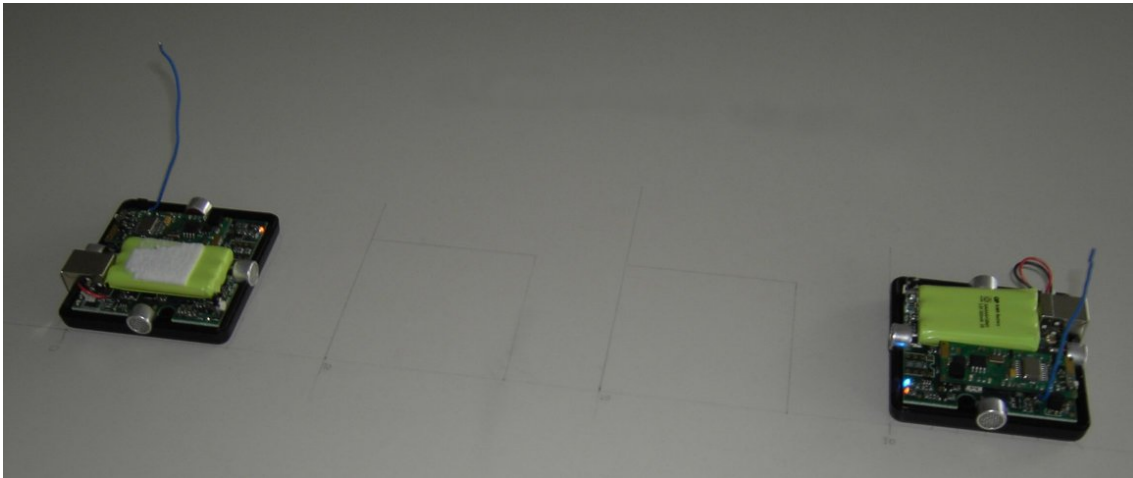
Abbildung 6.3: Zwei BRICK-Sensorknoten manuell positioniert und ausgemessen.
